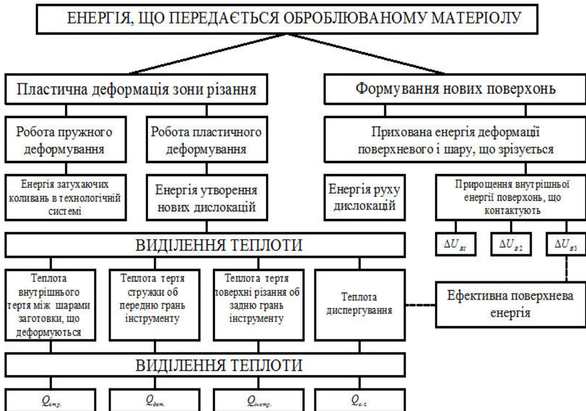
Рис 1. Структурна модель трансформації енергії в зоні різання.
