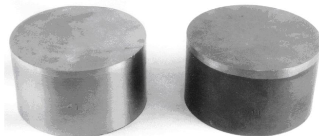
Рис. 1. – Загальний вигляд зразків із захисною наплавкою до (зліва) та після наводнювання
