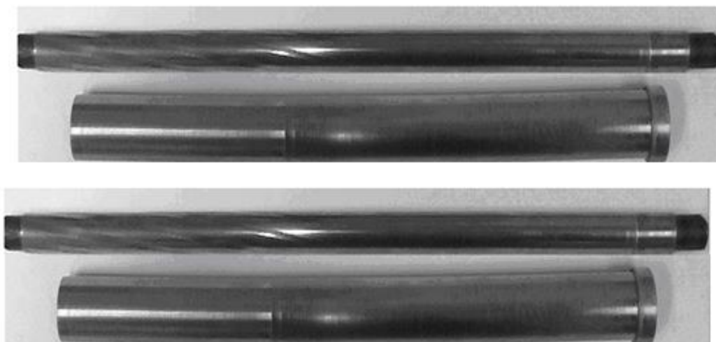
Fig. 5 – Shape mandrel and barrel of small arms, made by radial crimping method / Профильная оправка и ствол стрелкового оружия, изготовленный методом радиального обжатия
