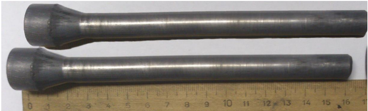
Fig. 2 – Barrel blanks obtained by hydrostatic extrusion method on the smooth mandrel / Ствольные заготовки, полученные путём гидрострузии на гладкой оправке
