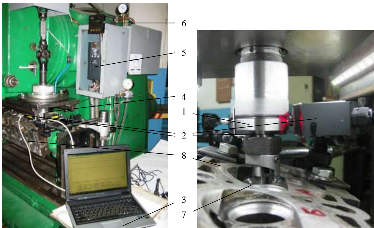
Fig. 3 - General view of the valve seat processing complex and hardware for spindle radial displacement control / Общий вид комплекса для обработки седел клапанов и аппаратуры для контроля радиальных перемещений шпинделя: 1 - test element / контрольный элемент; 2 - laser sensors / лазерные датчики; 3 - computer / компьютер; 4 - spindle of the machining appliance / шпиндель обрабатывающего приспособления; 5 - electric frequency variator / электрический вариатор частот; 6 - electronic tachometer / электронный тахометр; 7 - valve seat / седло клапана; 8 - ICE body / блок ДВС
