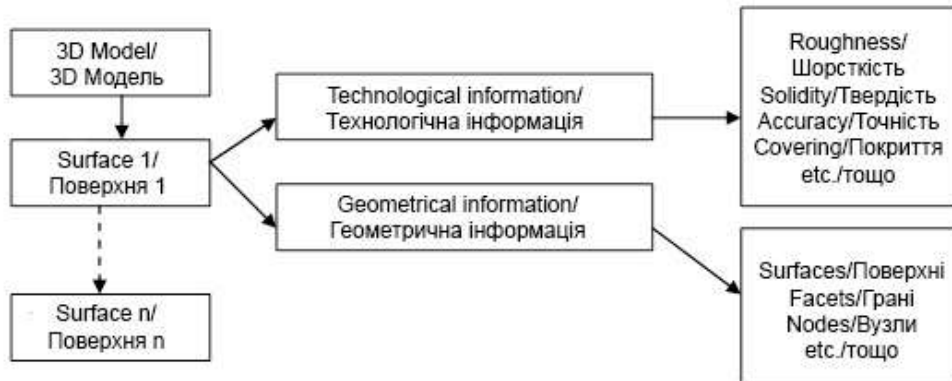
Fig. 2 – The general scheme of construction of information model of a part with technological component / Запропонована загальна схема побудови інформаційної моделі деталі з технологічною складовою
