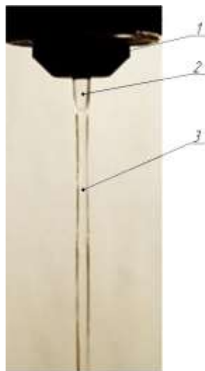
Fig. 1 – The air bubble inside the jet at the outlet of the nozzle indicates of harmful air injection phenomenon, that destabilizes the fluid flow parameters / Повітряна бульбашка всередині струменю на виході із сопла свідчить про шкідливе явище інжекції повітря, яке дестабілізує параметри потоку рідини: 1 – nozzle / сопло; 2 – bubble / бульбашка; 3 – jet / струмінь
