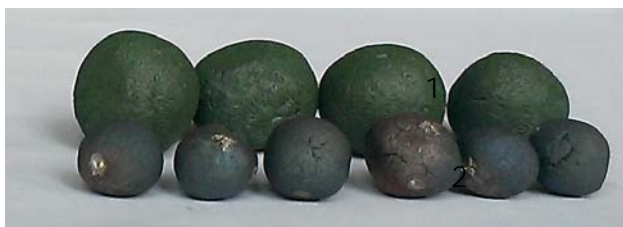
Рис. 2. Розміри котунів до (1) та після (2) термообробки.
