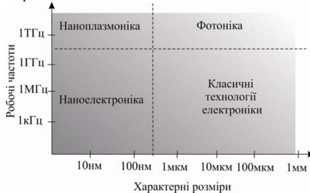
Рис. 12. Схематичне зображення наноплазмоніки на діаграмі робочі частоти–розміри активних елементів.
