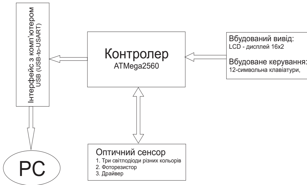
Рис. 4. Нейромеревий пристрій класифікації об'єктів за кольором їхньої поверхні
