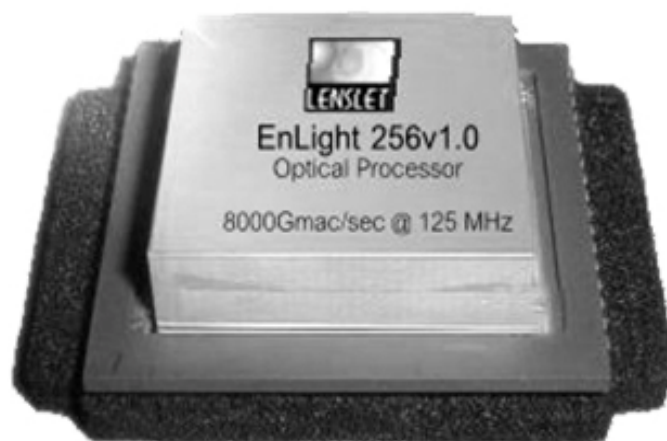
Рис. 6. Зовнішній вигляд процесора Enlight 256.
