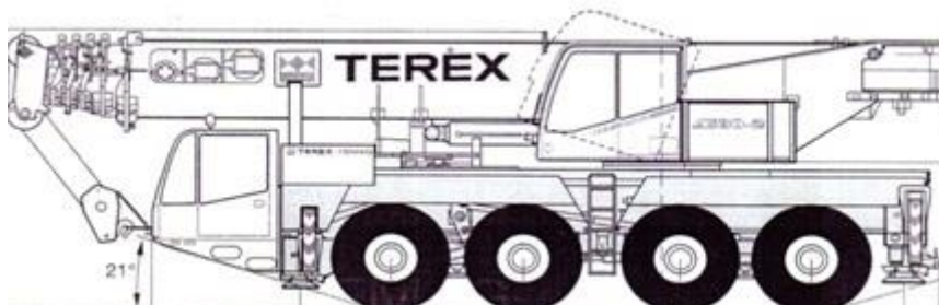
Рис. 16. Автокран "TEREX/DEMAG" (AC80-2).
