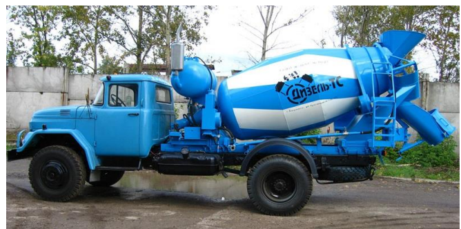
Рис. 8. Автобетонозмішувач фірми "Дизель ДС" об'ємом 2 \text{ м}^3 .
