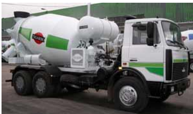
Рис. 14. Привод змішувального барабана від автономного двигуна.
