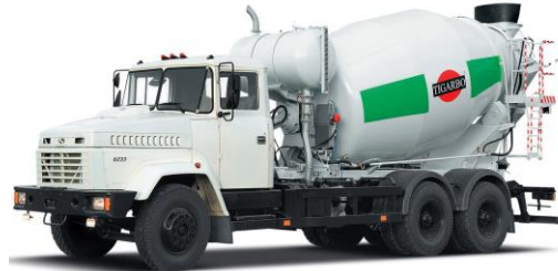
Рис. 2. Автобетонозмішувач із об'ємом 7 м 3 .
