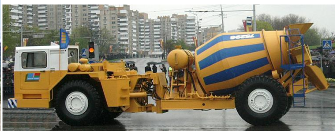
Рис. 10. Автобетонозмішувач BelAZ-75296 фірми БелАЗ.
