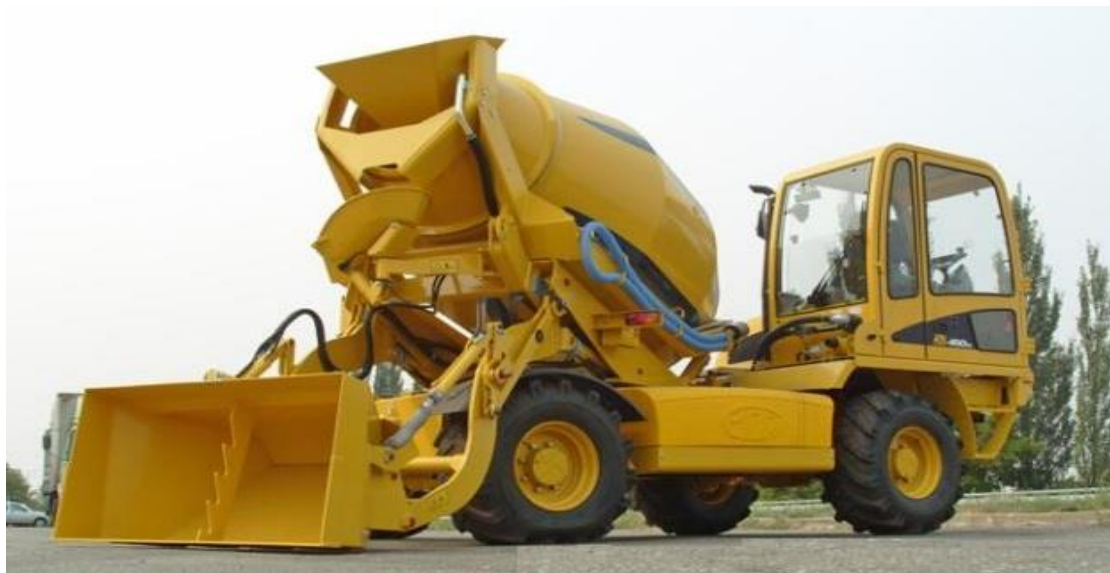
Рис. 16. Автобетонозмішувач з самозавантаженням.
