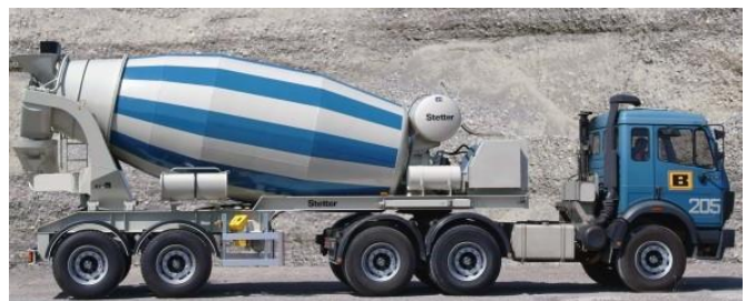
Рис. 4. Автобетонозмішувач із об'ємом 12 м 3 на напівпричепі.
