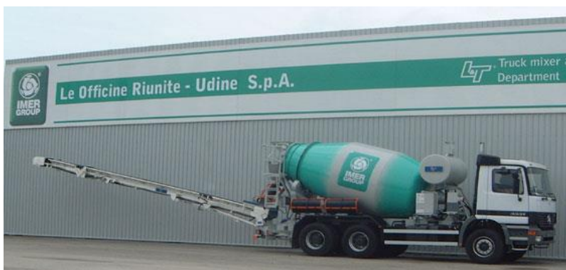
Рис. 11. Автобетонозмішувач з конвеєром фірми IMERGROU.
