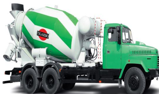
Рис. 15. Привод змішувального барабана від гідроприводу з відбором потужності від коробки відбору потужності шасі.
