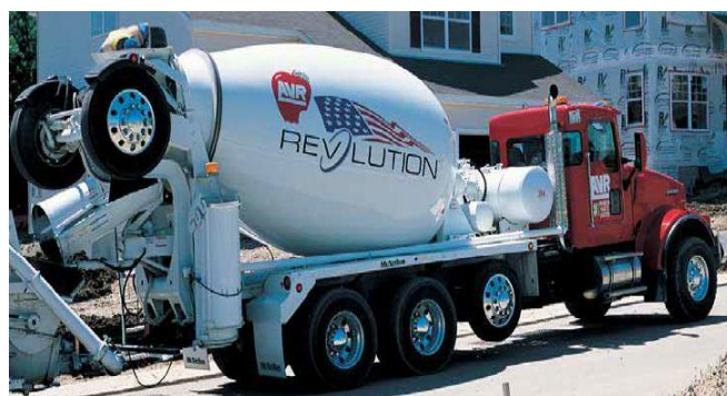
Рис. 13. Автобетонозмішувач з додатковим візком фірми Oshkosh.
