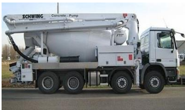
Рис. 10. Автобетонозмішувач з бетононасосом фірми Stetter.
