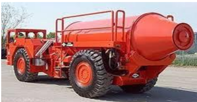
Рис. 9. Змішувач з горизонтальним барабаном фірми Normet.
