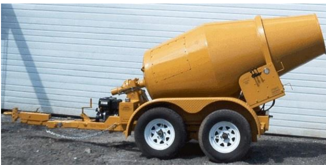
Рис. 7. Причпний змішувач із об'ємом 3 \text{ м}^3 .
