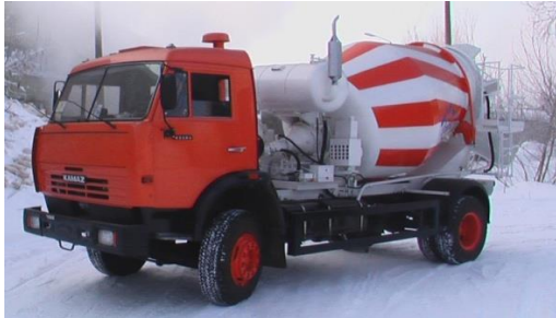
Рис. 1. Автобетонозмішувач із об'ємом 5 м 3 .
