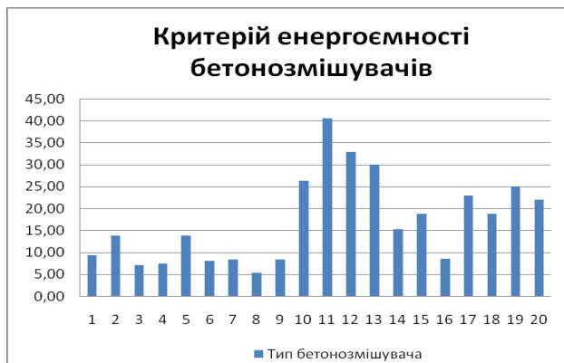
Рис. 3. Гістограми зміни критеріїв енергоємності бетонозмішувачів різних типів.
