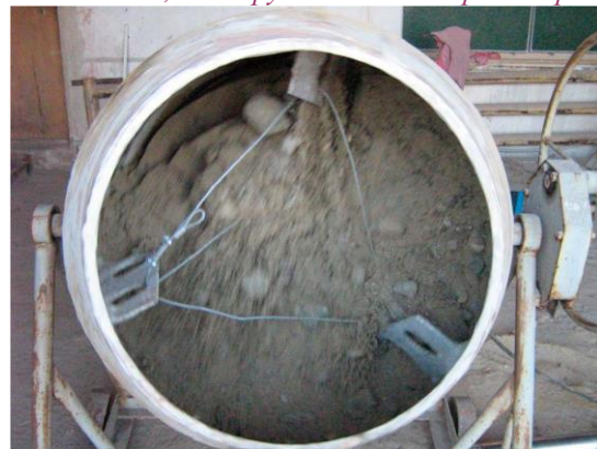
Рис. 2. Фото модернизированного гравитационного бетоносмесителя.
