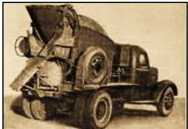
Рис.11. Післявоєнний автобетонозмішувач С-269 на шасі ЗИС-150 (40-і роки ХХ-го ст.)
