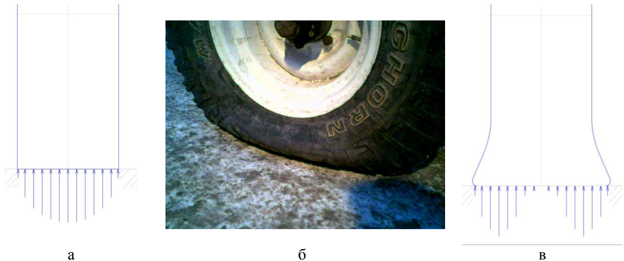
Рис. 3. Розподілення реакції в залежності від зміни тиску в шині. а – реакція поверхні дорожнього покриття від перекачування шини; б – недокачена шина; в - реакція поверхні дорожнього покриття від недокачування шини.
