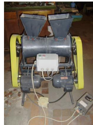
Рис. 3. Змішувач примусової дії для приготування сухих будівельних сумішей.
