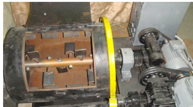
Рис. 1. Бетоносмеситель гравитационно-принудительного действия, работающий в каскадном режиме.
