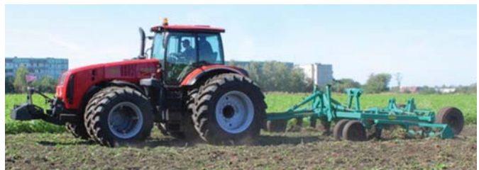
Рис. 1 – Загальний вигляд глибокорозпушувача ГР-5,4 в роботі з трактором «Белорус 3522»
