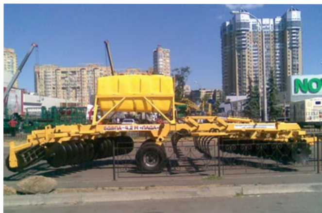
Рис. 2 – Борона важка модернізована БДВПА-4,2 М.01
