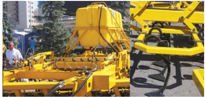
Рис. 6 – Модуль для внесення рідких комплексних добрив та аміачної води
