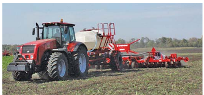
Рис. 5 – Трактор «Беларусь3522» в агрегаті з пневматичною сівалкою ОРІОН 9,6 виробництва ПАТ "Червона Зірка"
