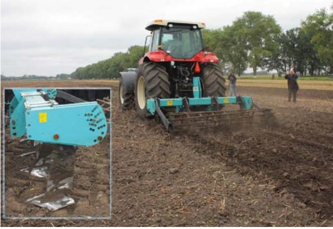
Рис. 2 – Загальний вигляд чизеля-глибокорозпушувача ЧГ-40-02 (з фрагментом робочих органів) в роботі
