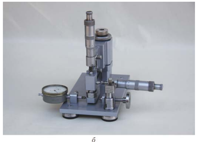
Рис. 1 – Пристрій для дослідження злушування насінин розторопші плямистої (а – принципова схема; б – загальний вигляд): 1 – базова плита; 2 – вертикальний стояк; 3 – консольна динамометрична балка; 4 – поворотна обойма; 5 – підшипники; 6 – гайка; 7 – контргайка; 8 – поворотна консоль; 9 – вертикально змонтований мікрометр; 10 – напрямний корпус; 11 – шток; 12 – штифт; 13 – горизонтально змонтований мікрометр; 14 – кронштейн; 15 – верхня робоча площадка; 16 – насінина; 17 – нижня робоча площадка; 18 – колодка; 19 – індикатор; 20 – тарувальний пристрій
