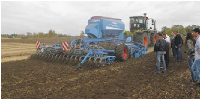
Рис. 2 – Посівний комплекс "Компакт-Солітер 9" виробництва фірми Лемкен в агрегаті з трактором Ксеріон потужністю 335 к.с. виробництва фірми Клаас в роботі
