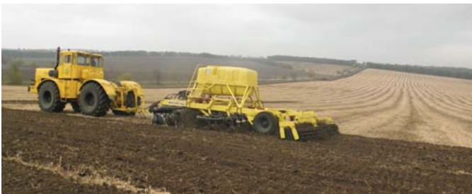
Рис. 1 – Українська причіпна дискова борона (модернізована, дисколапова) БДВПА- 4,2М.03 «Лада» в роботі в агрегаті з трактором К 700
