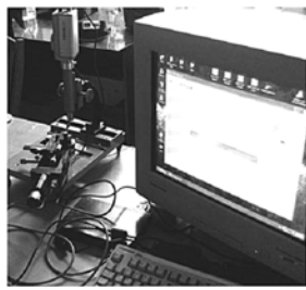
Рис. 3 – Структурні схеми та вимірювальні установки для вимірювання переміщень виконавчих елементів напрямних з п'єзоелектричним двигуном: а – лінійних параметрів позиціонування, б – кутових відхилень від прямолінійного ходу
