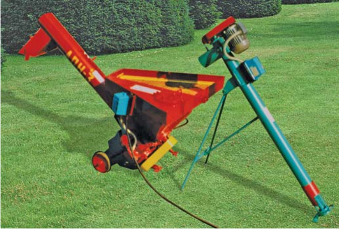
Рис. 4 – Універсальний шнековий протруювач з об'ємним дозатором насіння
