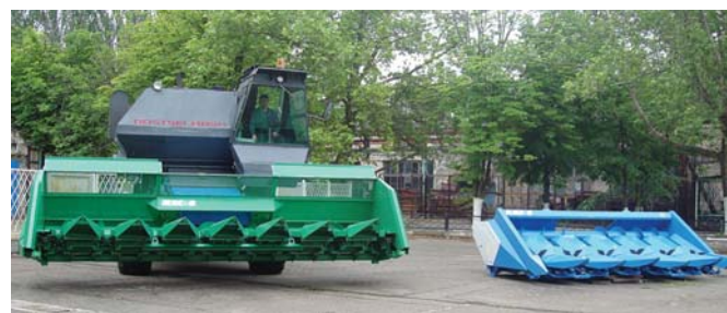
Рис. 3 – Комбайн «Нива-ефект» з похилистою камерою для навішування жниварок КМС-6 і ПЗС-8
