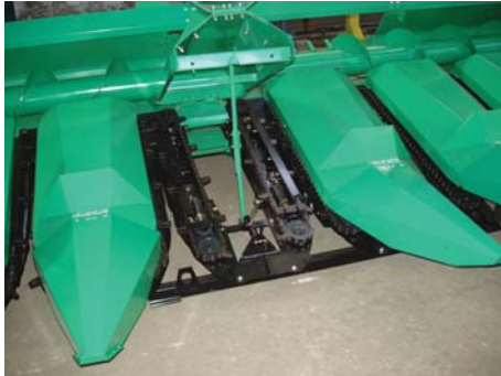
Рис. 4 – Посилена конструкція русла жнивarki КМС-8
