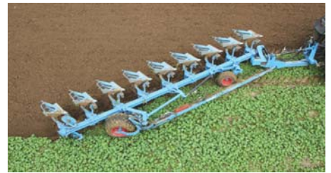
Рис. 8 – Обертовий плуг «Diamant 12» фірми «Lemken» (Німеччина)
