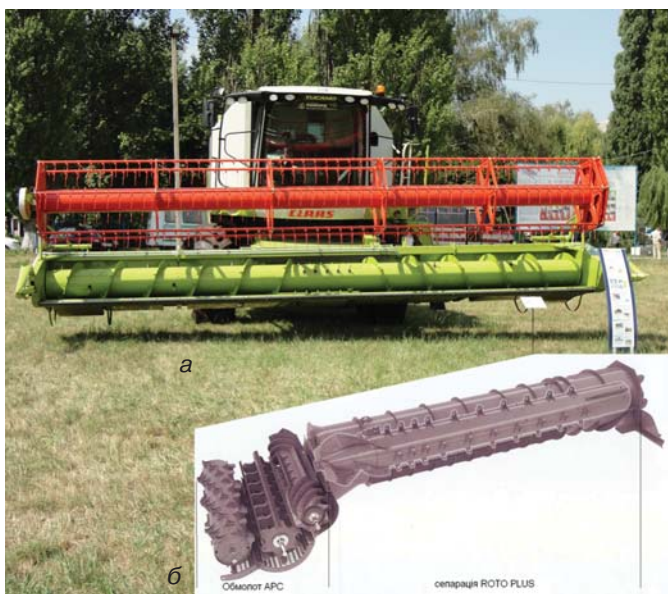
Рис. 3 – Комбайн зернозбиральний Tisano-470: а – в експозиції техніки агропроєкту «Агро Олімп», б – його молотарка комбінованого типу
