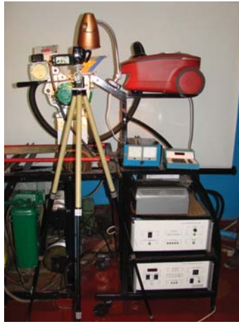
Рис. 4 – Загальний вигляд та схема комплексу з дослідження посівних систем КНТУ-80: 1 – липка стрічка чи липкий барабан, 2 – рама, 3 – бункер з насінням, 4 – тахометр, 5 – табло тахометра, 6 – манометр, 7 – механізм зміни частоти обертання вала, 8 – електропривод, 9 – вентилятор, 10 – регулятор вакууму, 11 – кронштейн вентилятора, 12 – відкидний стіл, 13 – опорні колеса, 14 – датчик контролю висіву насіння, 15 – класифікатор насіння, 16 – блок керування класифікатором, 17 – блок керування роботою висівного апарата, 18 – друкувальний пристрій, 19 – цифрова відеокамера, 20 – лампа підсвічування, 21 – місткості для насіння
