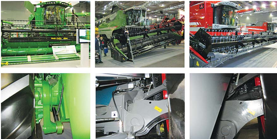
Рис. 15 – Системи попереднього вирівнювання молотарок на схилах до 20° фірми «Джон-Дір» та концерну «АГКО»
