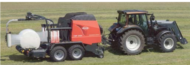
Рис. 22 – Комбінований агрегат для формування рулонів прив'яленої трави і обмотування їх поліетиленовою плівкою VBP 2160 фірми «Kuhn» (Франція)
