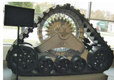
Рис. 18 – Гусенична ходова система італійської фірми «TIDUE»
