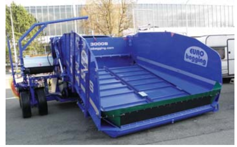
Рис. 23 – Агрегат для консервування кормів у довгих поліетиленових рукавах 3000S фірми «EURO bagging» (Чехія, Нідерланди)
