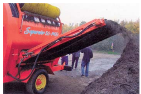
Рис. 33 – Агрегат для формування бурта подрібненої маси SCV фірми «Seko» (Італія)
