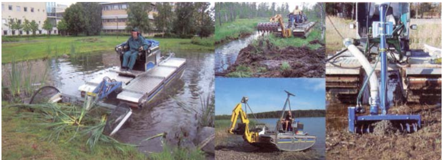
Рис. 14 – Агрегат для окультурення водоймищ та русел малих рік «Jednotka DM» фірми «Fakus» (Чехія)
