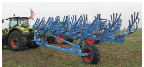
Рис. 3 – Восьмикорпусний плуг фірми LEMKEN (Німеччина)
