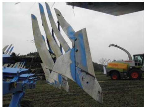
Рис. 4 – Нова конструкція відвала плуга фірми LEMKEN (Німеччина)
