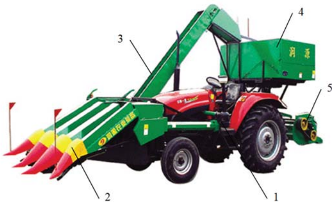
Рис. 2 – Кукурудзозбиральний модульний енергетичний засіб 4YW-3: 1 – трактор; 2 – качановідокремлювальний апарат; 3 – транспортер; 4 – бункер-навантажувач; 5 – подрібнювач
