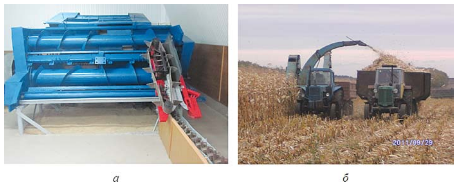
Рис. 4 – Вибір оптимальної конструкції качановідокремлювального апарата багатофакторної дії: а – загальний вигляд лабораторної установки, б – виробнича перевірка прийнятих рішень
