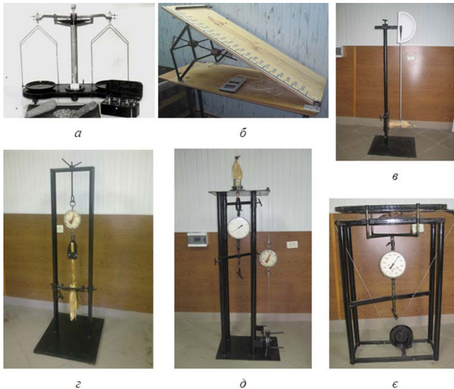
Рис. 3 – Загальний вигляд приладів для дослідження: а – розмірно-масових характеристик; б – фрикційних властивостей; в – пружних властивостей; г – опору плодоніжки розтягуванню та зламу; д – опору плодоніжки розтягуванню та крученню; е – критичного зусилля притискання качана під час кручення
