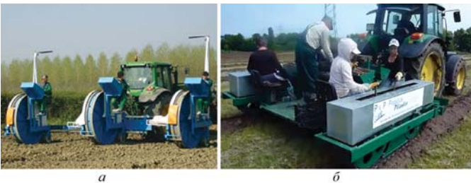
Рис. 2 – Машини, оснащені роликівими та транспортерно-гусеничними саджальними апаратами для садіння верби
