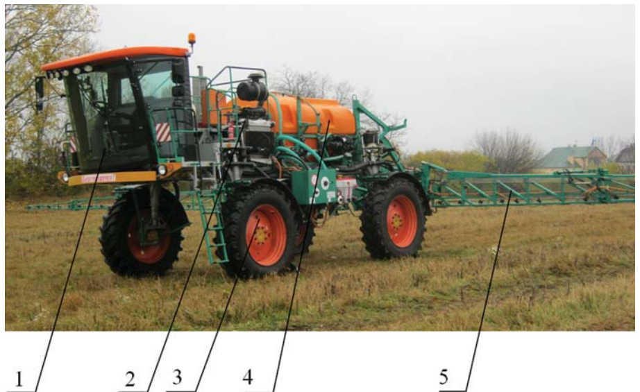
Рис. 1 – Загальний вигляд обприскувача: 1 – кабіна; 2 – двигун; 3 – шасі; 4 – бак для робочого розчину; 5 – штанга з розпилювачами
