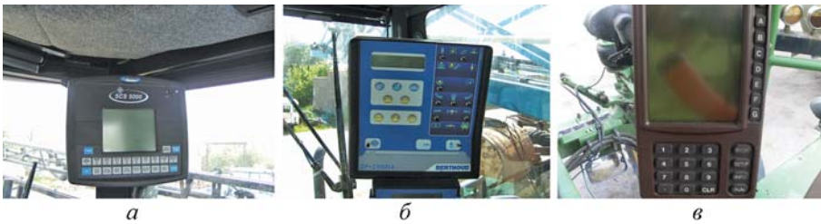
Рис. 4 – Бортові комп'ютери: а – Spra Coupe 7660; б – Raptor 4240; в – John Deere 4720
