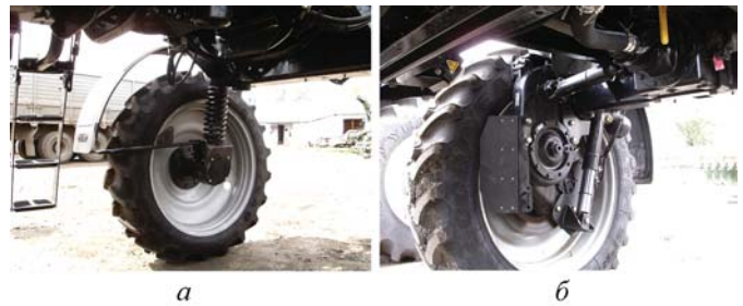
Рис. 2 – Підвіска передньої (а) та задньої (б) ходової системи самохідного обприскувача Spra Coupe 7660
