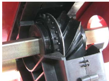
Рис. 2 – Висівний апарат з похилими ребрами котушки для зерна та котушка для дрібнонасінних культур
