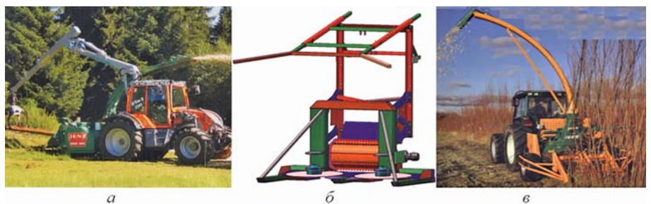
Рис. 6 – Самохідні машини для зрізування і подрібнення деревних енергетичних культур: а – деревоподрібнювальна машина НЕМ 360 ZA; б – пристрій до НЕМ 360 ZA для зрізування та подачі в камеру подрібнення пагонів енергетичних культур; в – комбайн для збирання деревних енергетичних культур Entrgyharvester
