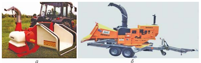
Рис. 5 – Мобільні машини: з приводом від ВВП енергетичного засобу (а) та автономного двигуна внутрішнього згоряння (б)
