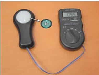
Рис. 11 – Люксметр для птахів фірми «Hato BV Lighting» (Нідерланди)
