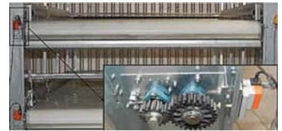
Рис. 12 – Система керування транспортером посліду фірми «Big Dutchman International GmbH» (Німеччина)
