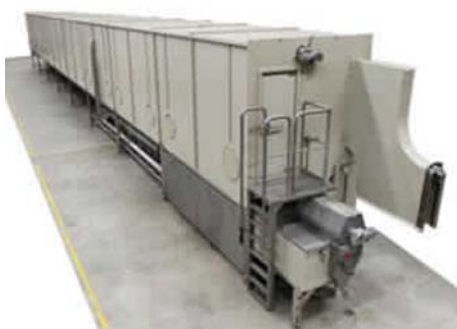
Рис. 1 – Система ошпарювання тушок птиці «AeroScalder» фірми «Marel Stork Poultry Processing» (Нідерланди)
