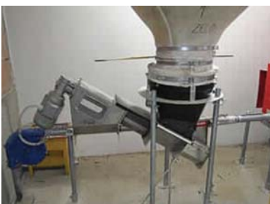
Рис. 8 – Кормоприймальна лійка фірми «Schauer Agrotronic GmbH» (Австрія)
