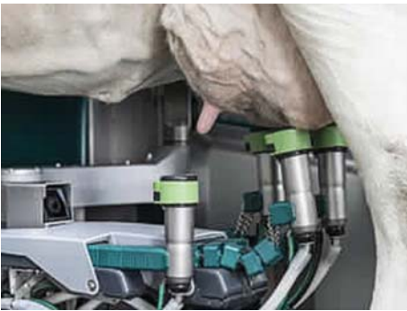
Рис. 4 – Доїльний модуль GEA для доїльних станків фірми «GEA Farm Technologies» (Німеччина)
