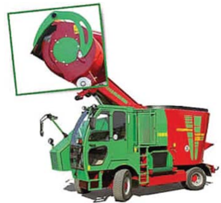
Рис. 16 – Самохідний фермський комбайн з різальним щитом «Verti-Mix» фірми «B. Strautmann & Sohne» (Німеччина)
