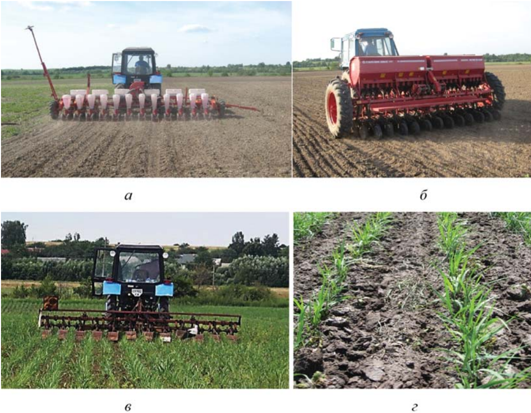
Рис. 5 – Сівба світчграсу сівалками УПС-12 (а) та СЗ-3,6А (б), міжрядний обробіток фрезерним культиватором КФ-5,4 (в); рослини світчграсу через 3 місяці після сівби (г)
