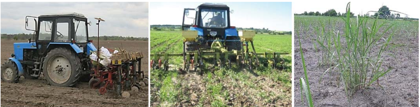
Рис. 4 – Міскантусо-саджальна машина (а), культиватор-рослинопідживлювач енергетичних культур (б), рослини міскантуса через 3,5 місяці після посадки (в)
