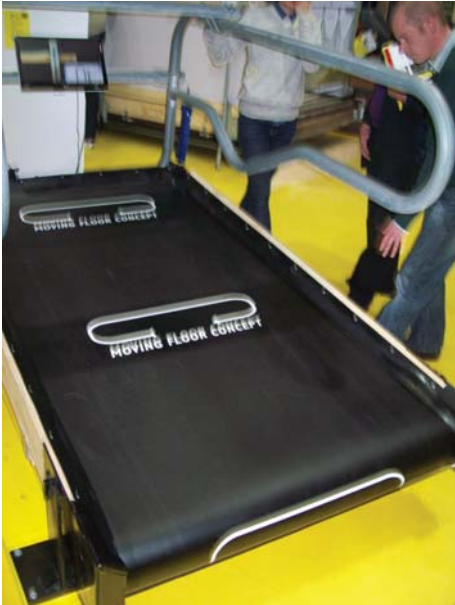
Рис. 7 – Бокс для корів з рухомою підлогою
