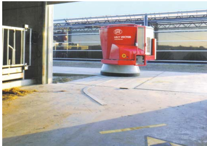
Рис. 10 – Самохідна роботизована універсальна установка для приготування і роздавання кормів
