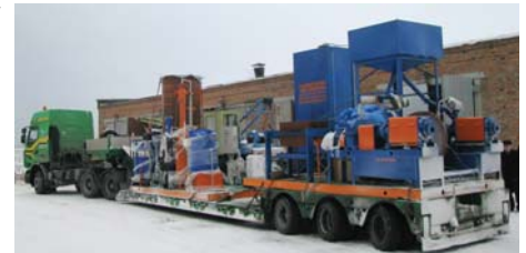
Рис. 3 – Мобільний завод, продуктивністю 3 тонни біопалива на добу, після транспортування у м. Чигирин
