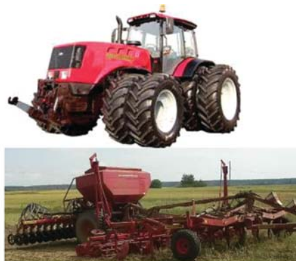
Рис. 2 – Умови виконання агротехнологічної операції (а) агрегатом Беларус 3022 + Лидсильмаш АПП-6П (б)
