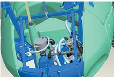
Рис. 11 – Змішувач типу Циклон з безпосереднім упорскуванням декількох препаратів фірми BERTHOUD (Франція)
