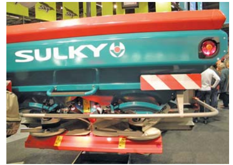
Рис 19 – Автоматизована система керування відцентровими розкидачем добрив "Ready To Spread" фірми SULKY (Франція)
