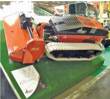
Рис 14 – Радіокерований гібридний самохідний прибиральник "DARGREEN 45 Н" фірми DARIO DEVELOPPEMENT
