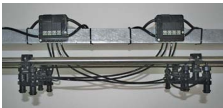
Рис. 18 – Система "SECTION-Control TOP" для індивідуального керування тримачами форсунок на штанзі обприскувача фірми MULLER-ELEKTRONIK (Франція)
