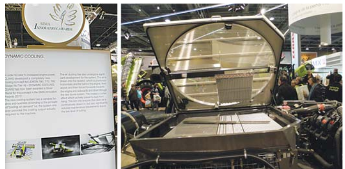
Рис. 4 – Система динамічного охолодження двигуна зернозбирального комбайна фірми CLAAS (Німеччина)
