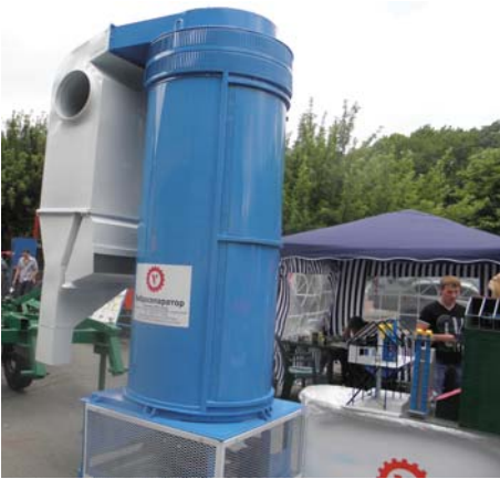
Рис. 1 – Модернізований сепаратор БЦСМ-50А фірми «Вібросепаратор»
