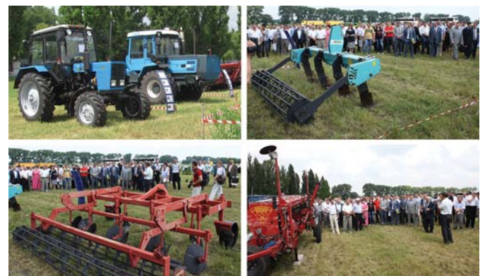
Рис. 9 – Зразки техніки, пропоновані для реалізації диференційованої системи обробки ґрунту, у День поля – 2013: трактор МТЗ-892 (ТОВ «Техноторг»), обладнаний навігаційною системою CLAAS Copilot TS і трактор ХТЗ-17221 (ПАТ «ХТЗ»), обладнаний підрулювальною системою Оп Трас 2, чизель-глибокорозпушувач ЧГ-40-02 виробництва ТОВ «Краснянське СП «Агромаш», культиватор дисково-лаповий КЛД-3 виробництва ПАТ «ЛКМЗ», сівалка зернотукова механічна СЗМ-4 «НІКА» виробництва ПП ВФК «Велес Агро»
