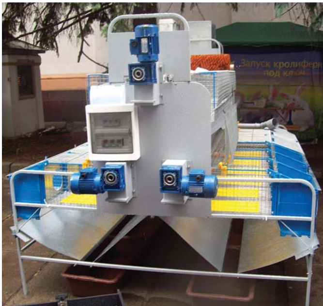
Рис. 6 – Кліткове обладнання для утримання кролів КМФ-2 ТОВ «Панкроль»
