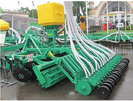
Рис. 15 – Загальний вигляд ґрунтообробно-посівного агрегату ТОВ НВП «БІЛОЦЕРКІВМАЗ» з подачею пневмонасінневої суміші до дискових сошників
