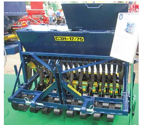
Рис. 10 – Загальний вигляд зернової сівалки для особистих і малих фермерських господарств СЗН 17/75 виробництва СТ ВФ «Агрореммаш»
